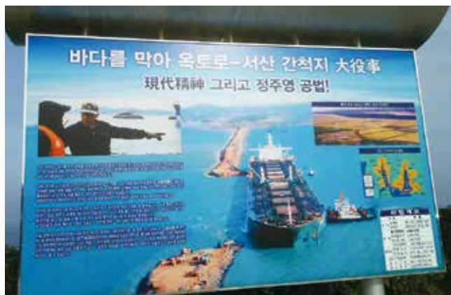
1984年当時干拓地の防潮堤の連結のための防水工事に長さ320メートルの超大型廃油造船に水を溜めて沈ませ、工期を3年も短縮、工事費を290億ウォン(約29億円)節減したといわれる「鄭周永工法」の施行現場。世界土木建設史上、前例のない工法と言われている。
